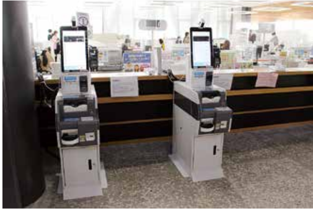
キャッシュレス決済に対応したセミセルフレジ (庁舎1階市民生活課窓口)
