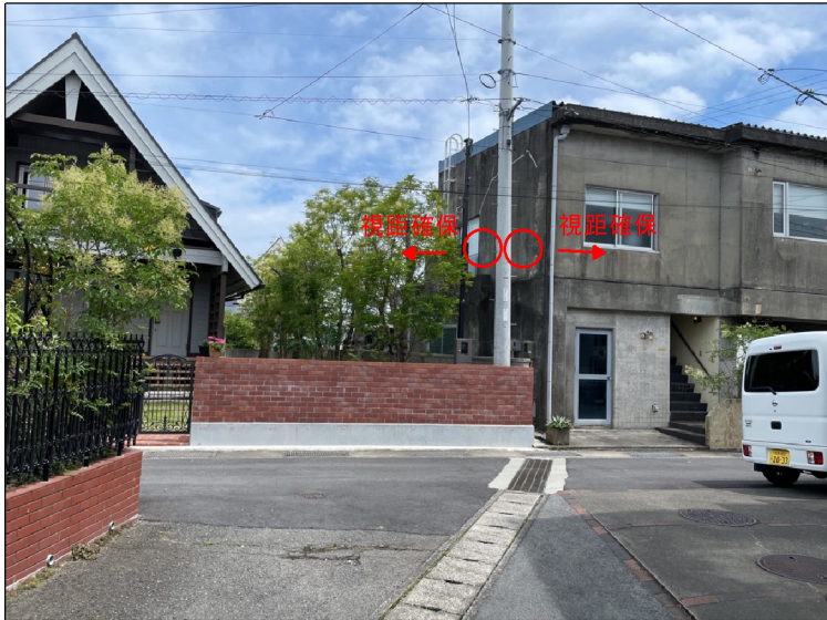
市道青木長浜線 S=1/50 道路反射鏡設置（削孔基礎） N=1基（φ 800, 1面鏡）
