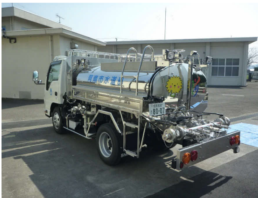
加圧式給水車(タンク容量:2,000L)
