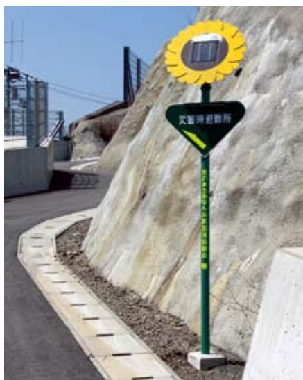
橋防災公園登り口に設置されている誘導灯。
