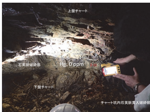
図 12. 採掘坑跡 1 坑内の pXRF による計測地点 (2-11) と Hg 値
