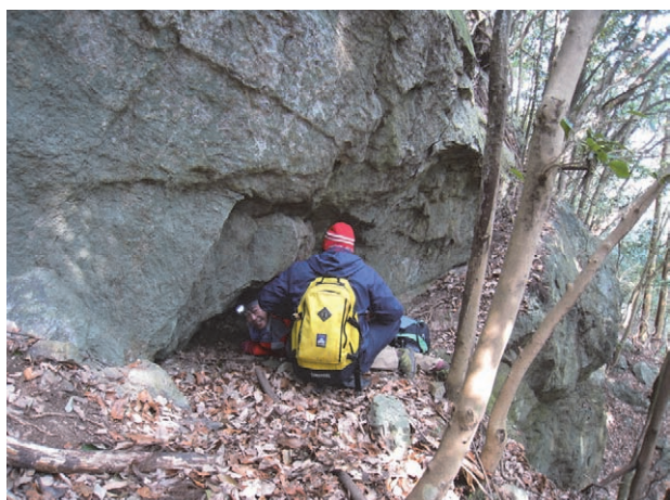
図8. 採掘坑跡1 南口に貫入する石英脈の採掘により露出した鏡肌面（人物右手の落ち葉部分）と掘削によりできた岩底（人物上部）
