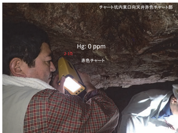
図 16. 採掘坑跡 1 坑内の pXRF による計測地点 (2-15) と Hg 値
