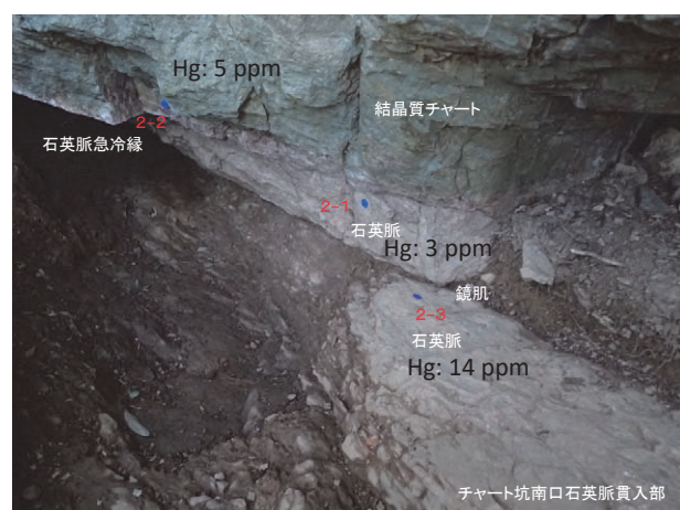
図7. 採掘坑跡1 南口に貫入する急冷縁(累被縞状構造)のある石英脈と pXRF による計測地点の Hg 値
