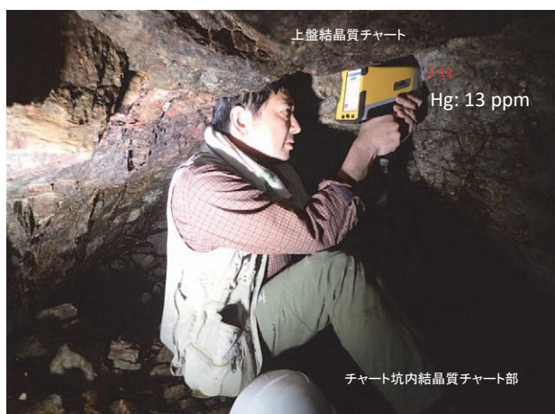
図 13. 採掘坑跡 1 坑内の pXRF による計測地点 (2-12) と Hg 値
