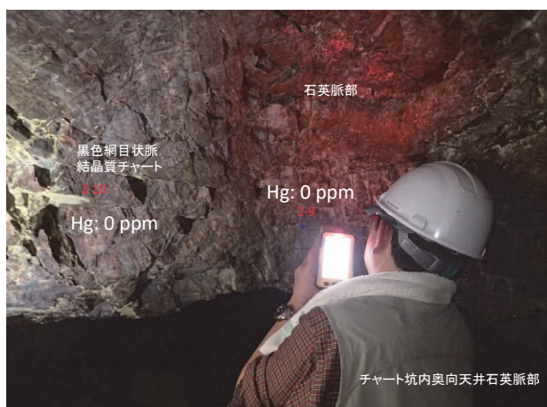
図 11. 採掘坑跡 1 坑内の pXRF による計測地点 (2-9、2-10) と Hg 値
