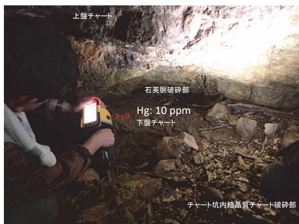
図 14. 採掘坑跡 1 坑内の pXRF による計測地点 (2-13) と Hg 値
