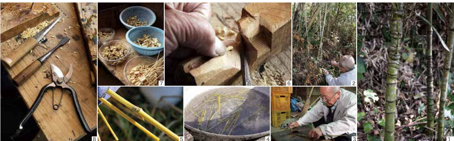
1下部の節間が不規則に短く詰まっている五三竹2のこぎりで根元から伐採する3電気ノコギリで幹をカット4直径80cmの大釜で30分程度ゆがく5油抜きすると透明感のある黄白色に変色6溝を彫った板に部品の竹を押つけて固定し、小刀を当てて竹を削る7部分ごとに作り置きしたパーツ群8切れ味抜群の小刀、ノミ、はさみ
