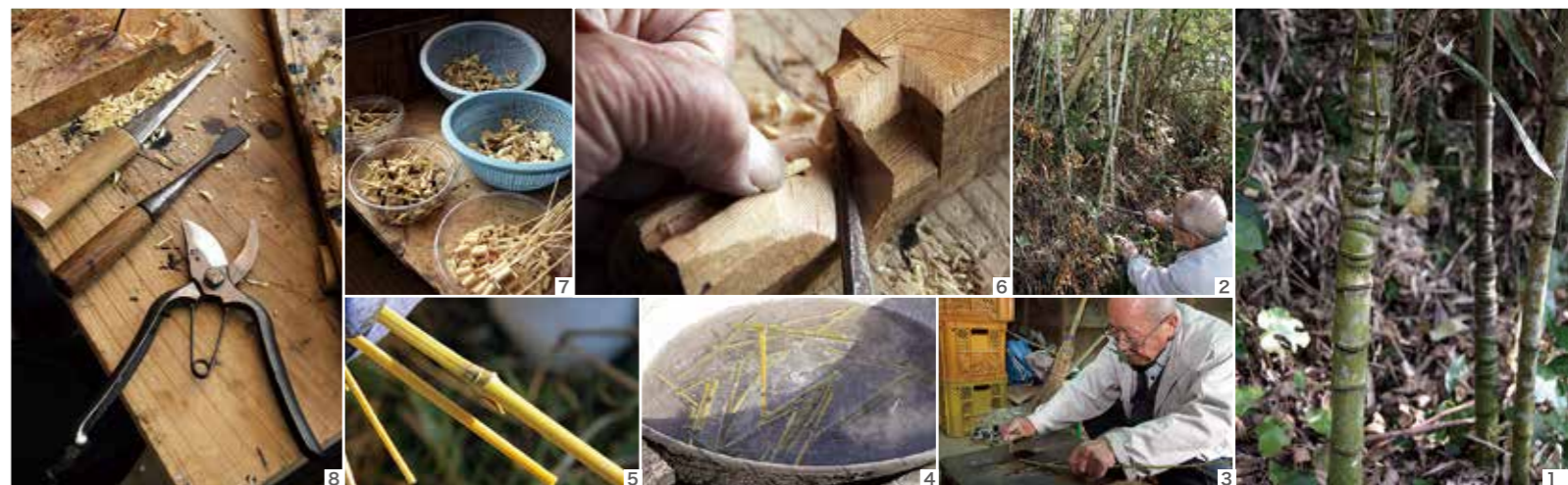
1 下部の節間が不規則に短く詰まっている五三竹 2 のこぎりや根元から伐採する 3 電気ノコギリで幹をカット 4 直径80cmの大釜で30分程度ゆがく 5 油抜きすると透明感のある黄白色に変色 6 溝を彫った板に部品の竹を押しつけて固定し、小刀を当てて竹を削る 7 部分ごとに作り置きしたパーツ群 8 切れ味抜群の小刀、ノミ、はさみ
